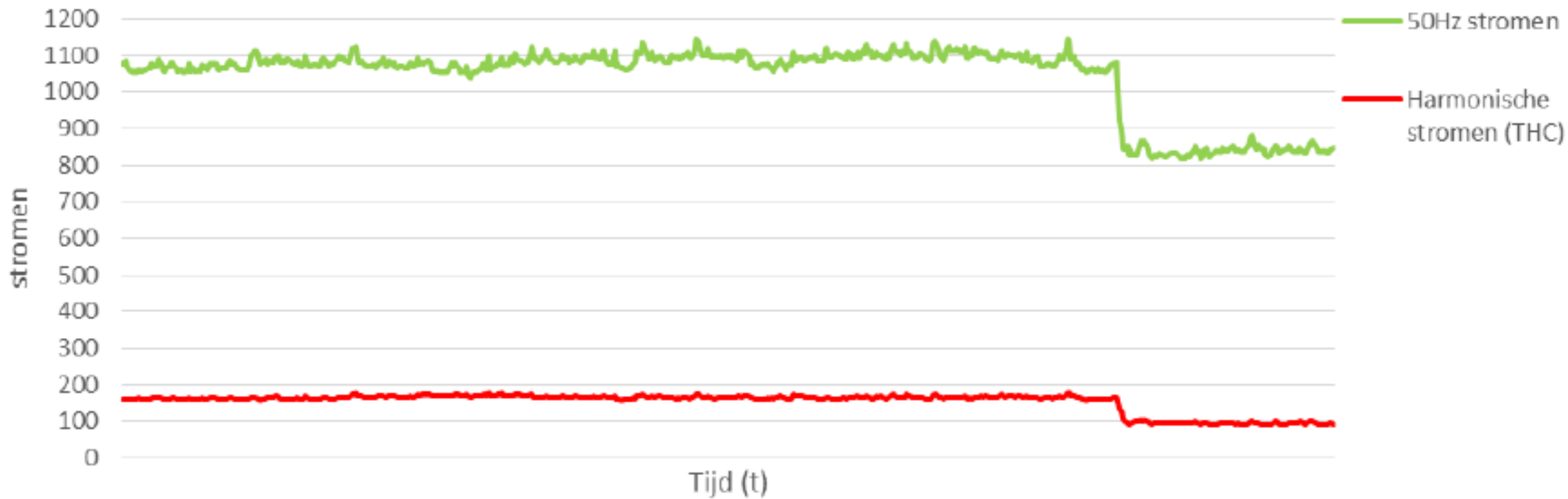
Gemeten stromen hoofdverdeler transformator 3
